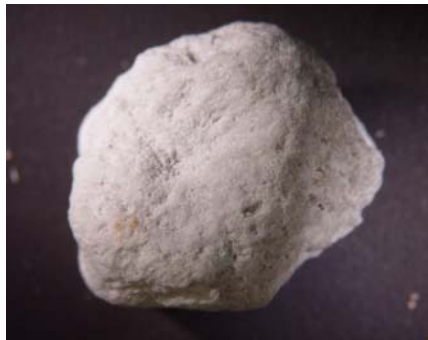
Εικόνα 3.4: Στερεοσκοπική εικόνα τεμαχίου κίσηρης (x 65).
